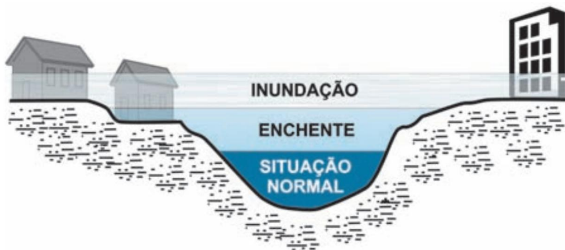
Figura 2.1 - Perfil esquemático do processo de enchente e inundação (MIN. CIDADES/IPT, 2007).
